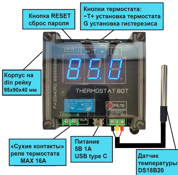
\* Для изменения температуры термостата и гистерезиса можно использовать кнопки прибора или ввести значения через веб интерфейс точки доступа термостата, а также отправить соответствующие команды из telegram чата.
